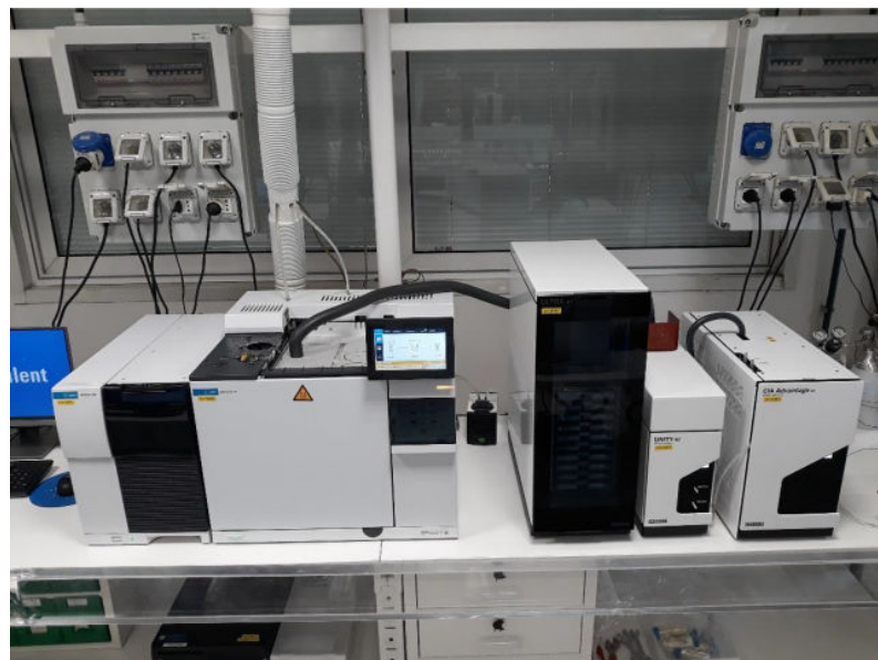
Fig. 1: Sistema termodesorbitore GC-MS
