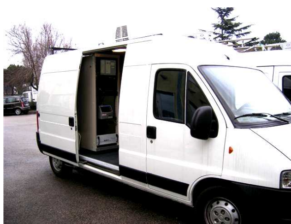
Furgone attrezzato per il controllo in continuo delle emissioni secondo la UNI EN 14181: QAL2 e AST
