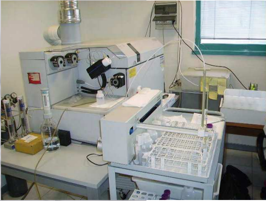
spettrometro di massa con sorgente al plasma ICP-MS 7500ce
