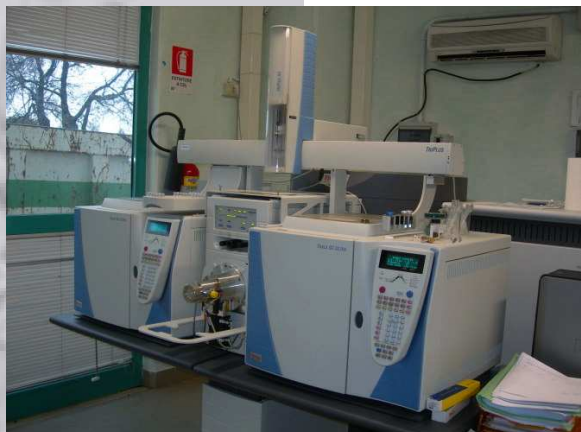
Spettrometro di massa ad alta risoluzione magnetico (HRMS) con modello DFS Dioxine B
