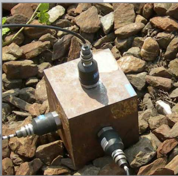
accelerometri sismici PCB per i rilievi su edifici
