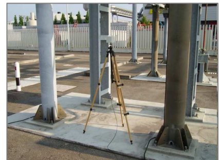
sonda per campi elettromagnetici EHP 50B – campo di frequenza 5Hz – 100KHz
