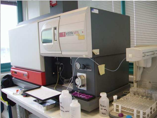
spettrometro simultaneo ad emissione atomica con plasma ad accoppiamento indotto ICP-AES Vista-MPX dotato di autocampionatore SPS-3, Varian
