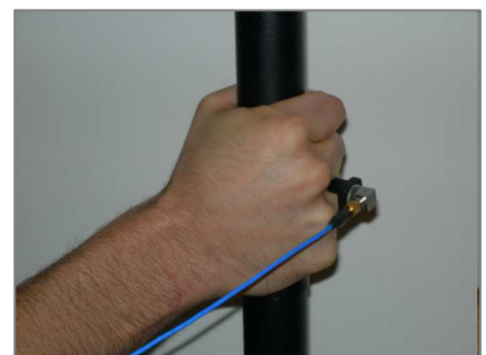
accelerometri PCB triassiali per i rilievi sul sistema mano-braccio e sull'intero corpo in ambienti di lavoro
