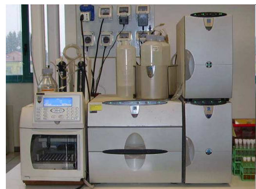
cromatografo ionico DIONEX ICS 3000 munito di 1 rilevatore conduttimetrico, rilevatore ad amperometria pulsata, con sistema a generazione di eluente, completo di autocampionatore a 40 posti termostato
